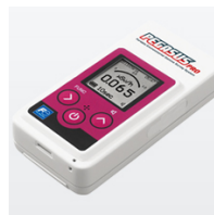
携帯型環境ガンマ線測定器 (半導体検出器、Cs(Tl)検出器)
