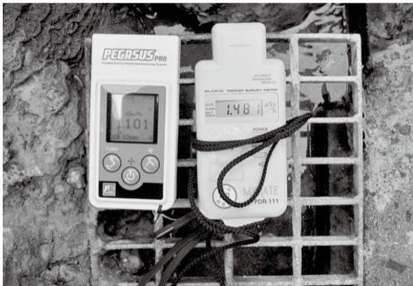
図2 池田鉱泉における環境中の放射線。ラドンの娘核種による 1 \mu\text{Sv/h} 以上の空間線量率が観測されます。これは福島県内におけるCs-137/Cs-134による汚染が除染済みと判定する線量率の4倍以上に相当します。なお長崎市では一般環境の空間線量率が 0.1 \mu\text{Sv/h} を上回ることはありません。
